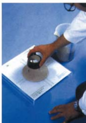
Měření rozlivu potěru
