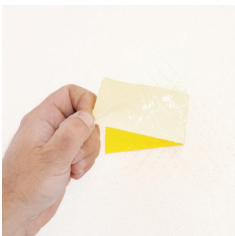
Obr.1 Příp. zkouška přídržnosti podkladních vrstev.
