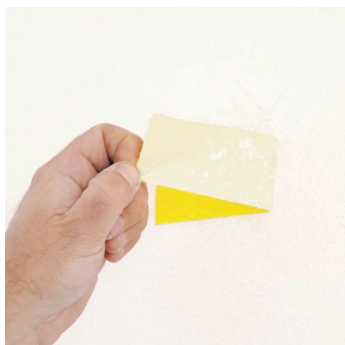
Obr.1 Příp. zkouška přídržnosti podkladních vrstev.
