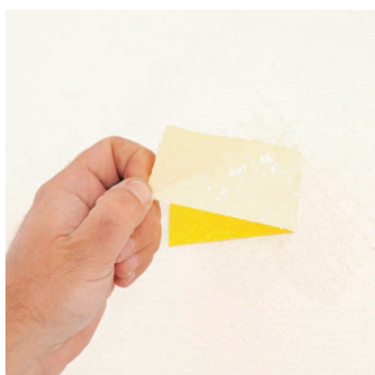
Obr.1 Příp. zkouška přídržnosti podkladních vrstev.
