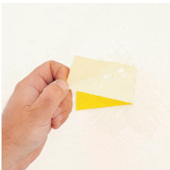
Obr.1 Příp. zkouška přídržnosti podkladních vrstev.
