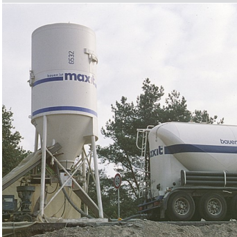
Obr.1 Stálá zásoba materiálu v síle.
