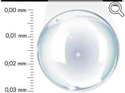
Einzelne Mikrohohlglaskugel, ca. 1.100-fach vergrößert
