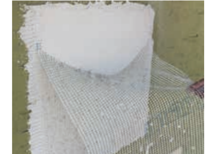
Überprüfung der Tragfähigkeit durch einen Gewebeabreißtest mit maxit multi 280 und maxit Armierungsgewebe MW.
