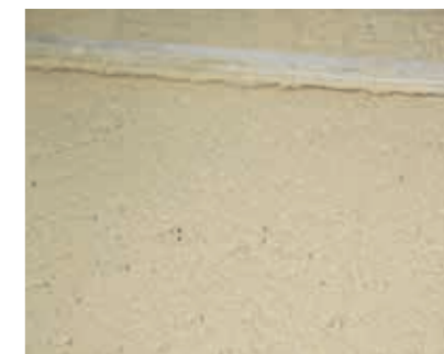
Auftragsstärke, Werkzeug und Druck auf das Werkzeug bestimmen die Oberflächenstruktur. Körnung wird mit der Latte gezogen.
