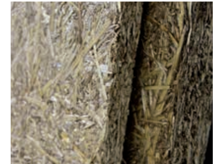
maxit Strohpanel Putzträgerplatte, unbeschichtet.
