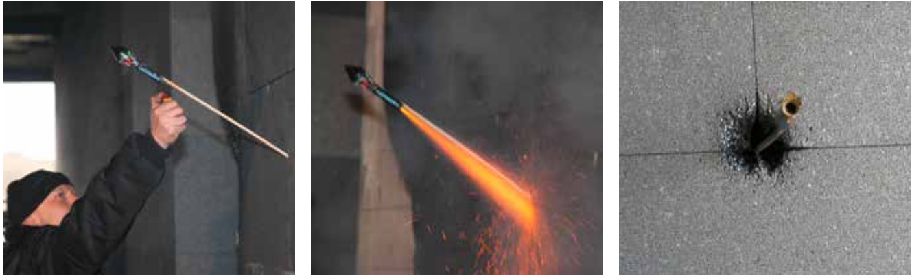
Bild 33: EPS-Dämmung als „Startrampe“ einer Silvesterrakete, Brenndauer 10 s; keine Entflammung, nur oberflächige Schmelzprozesse
