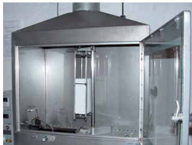
Bild 7: Brennkasten mit eingebauter Probe
