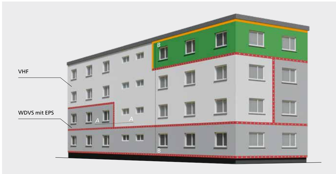
Abbildung 39: Beispielhafte Ausführung bei Übergängen von WDVS zu VHF, diese sind brandschutztechnisch zu trennen
