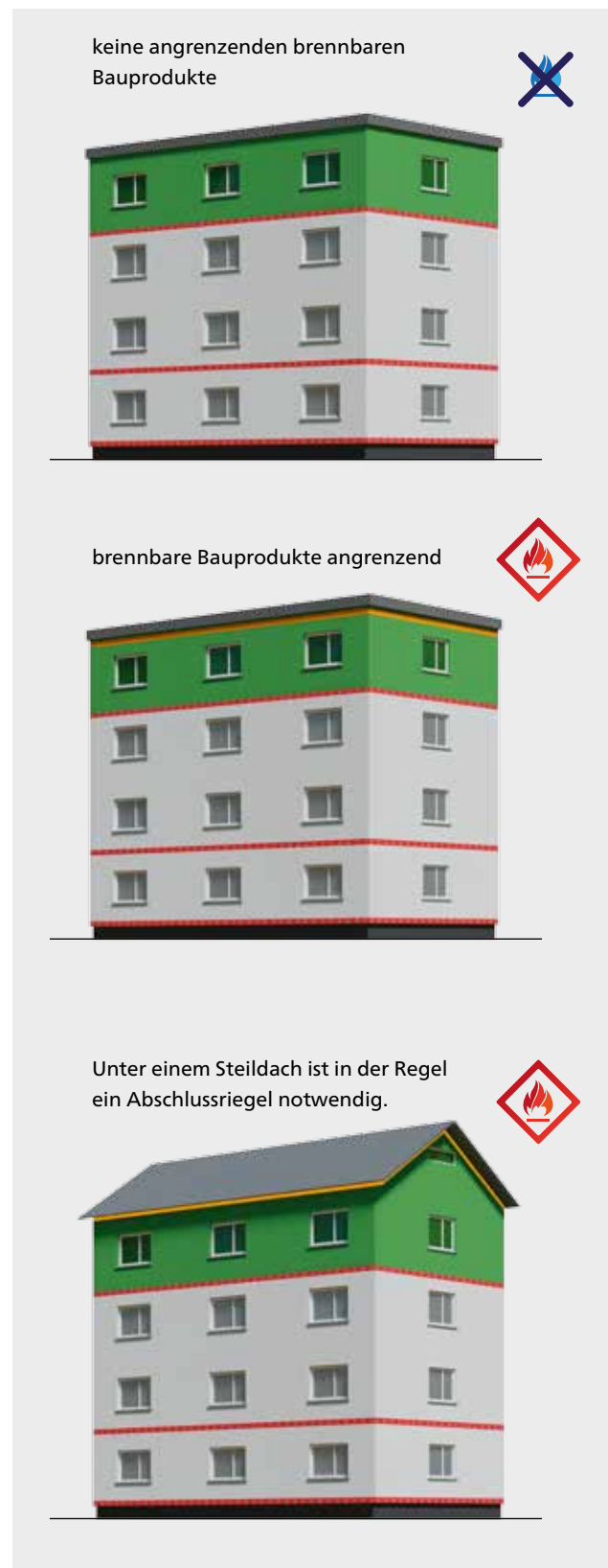
Abbildung 35: Ausführung von „Abschlussriegeln“ unterhalb von Dächern
