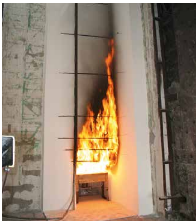
Bild 10: Brandprüfung im Originalmaßstab nach DIN 4102-20 (EPS-WDVS, 30 cm Dicke, Brandriegel)
