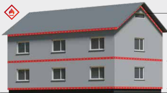
Abbildung 46: Beispielhafte Ausführung der Brandschutzmaßnahmen bei einem brennbaren Steildach
