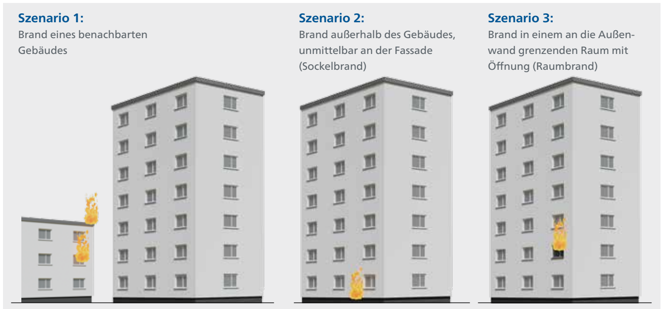
Abbildung 1: Brandszenarien an der Gebäudeaußenwand
