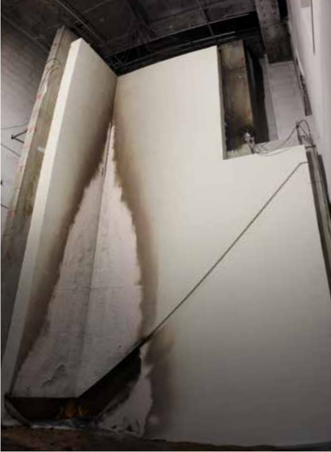
Bild 29: Brandschädigung (mit Putzsystem / nach Entfernung des Putzsystems)
