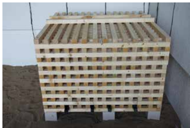
Bild 19: Brandlast (Holzkrippe) dem Probenkörper
