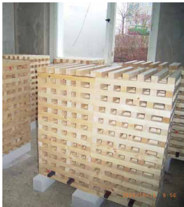
Bild 13: Brandlast (Holzkrippen) im Raum
