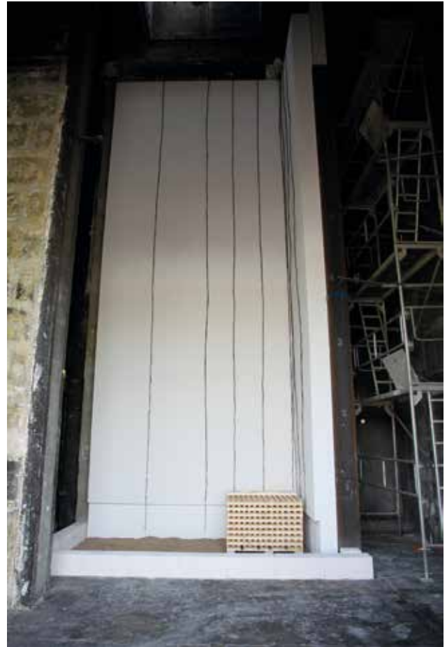
Bild 22: Versuchsaufbau mit WDVS verputzt
