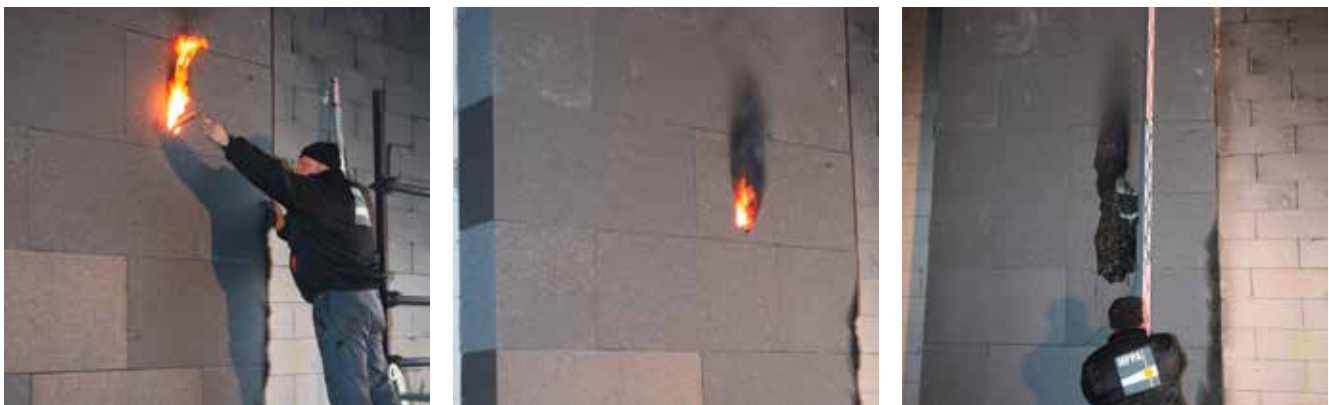
Bild 34: „Bengalo“ (Brennzeit 4 Minuten) brennend in EPS-Dämmung gesteckt
