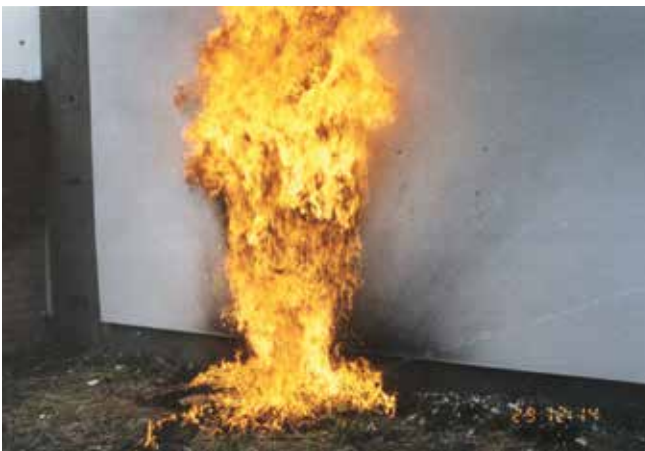
Bild 36: Brandbeschleuniger (2 l Benzin) flächig auf EPS-WDVS geschüttet
