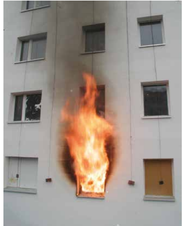
Bild 14: Brandentwicklung vor der Fassade bei einem Raumbrand
