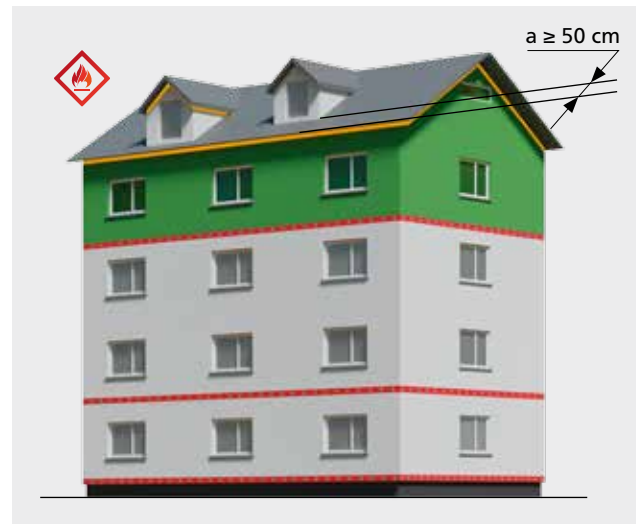
Abbildung 37: Ausführung von Abschlussriegeln unterhalb eines „ausgebauten“, brennbaren Steildaches mit Aufenthaltsräumen und Dachgauben, die mit EPS-WDVS gedämmt sind
