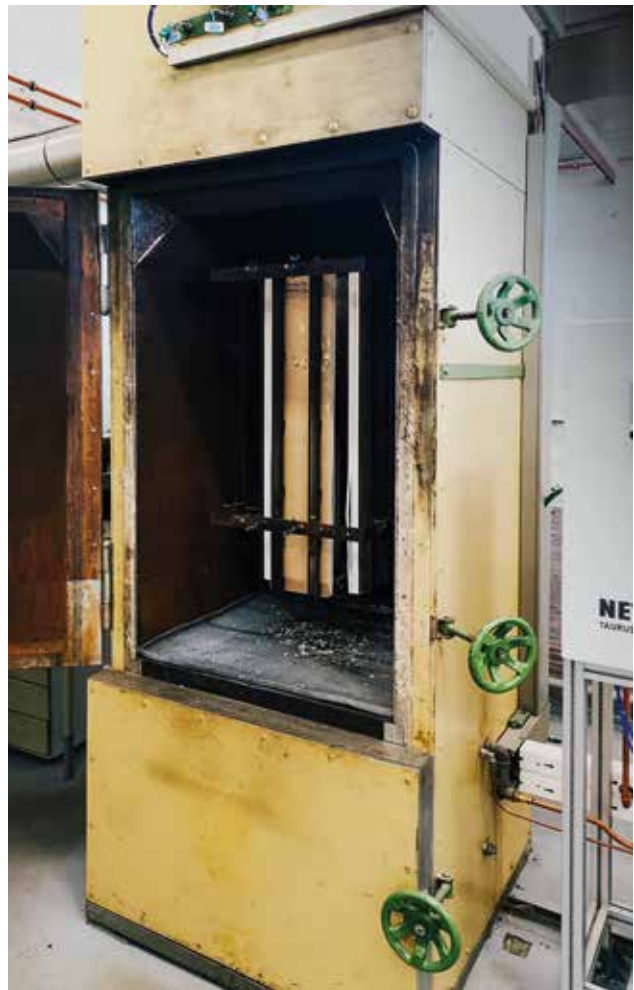
Bild 8: Brandschacht mit eingebautem Probenkorb
