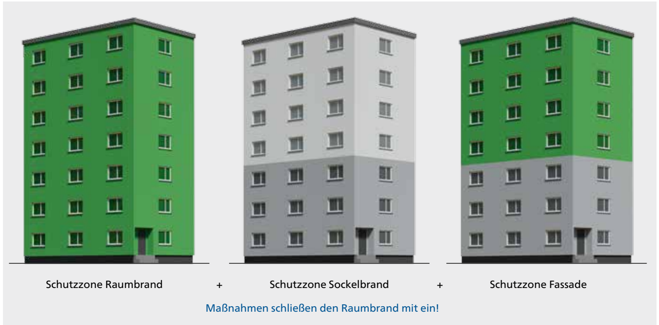
Abbildung 11: Brandschutztechnische Schutzzonen an Fassaden
