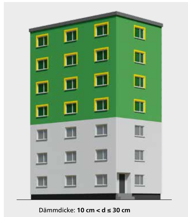
Abbildung 20: Dreiseitige Umschließung bei vorgesezten Fenstern
