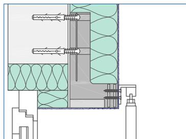
Führungsschienen für Schiebeläden
