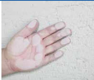
Wischprobe auf Staubfreiheit/Kreideverhalten
