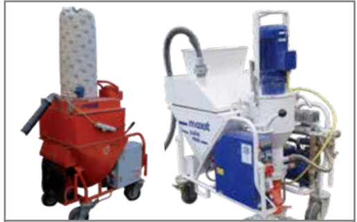
Filterhaube bei Trockenförderung / Dämmputzhaube mit Staubabsaugung
