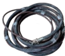
1 Mörtelschlauch 25 mm, ca. 10 m
